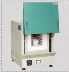
SXW型1100℃ 上开式箱式电炉 适宜实验室放置坩埚等热处理 炉膛尺寸: 300×180×180 3.6KW
