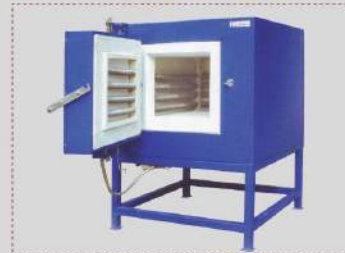
五面加热玻璃热处理炉 五面加热/高精度/控制温度±1℃/炉温均衡度±5℃
