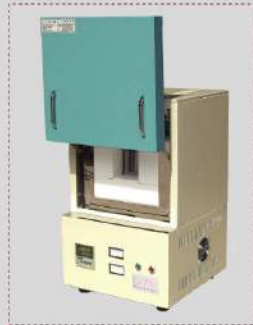
实验室高温烧结炉SXW-3-14 德国进口陶瓷纤维板炉膛 50段程控微电脑智能控制 炉膛尺寸: 150×120×120 200×150×120 额定温度: 1400℃ (可以升级至1600℃)
